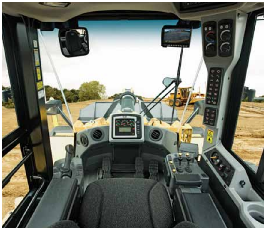
Motoniveladora: troca de alavancas por joysticks aumenta o campo de visão do trabalhador
